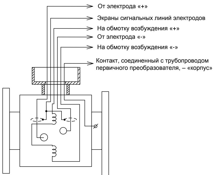
Рисунок Г.1 Общая схема первичного преобразователя расхода
